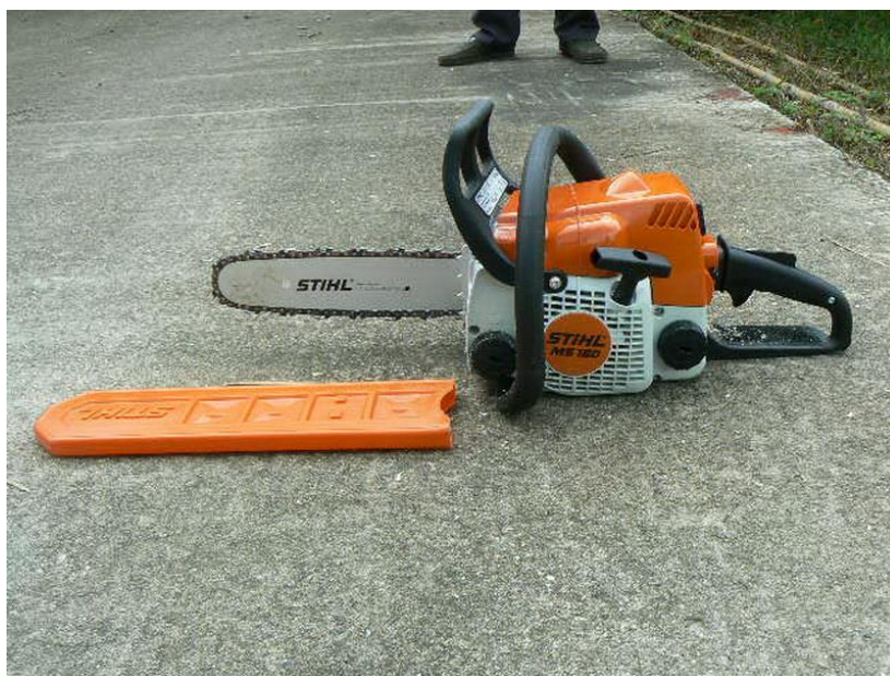
เลื่อยยนต์ที่ใช้ในการเลื่อยไม้ยางพารา และอุปกรณ์ป้องกันใบเลื่อย
